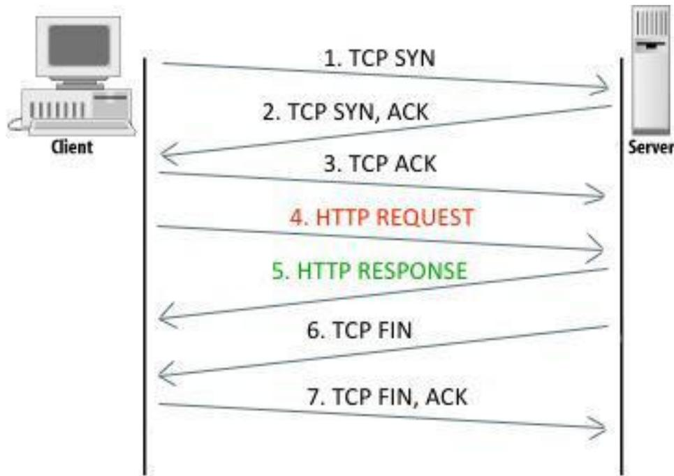
Fig. 8.1: Connessione TCP tra Client e Server
